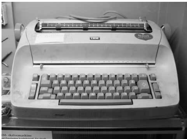
BM-skrivemaskine, en såkaldt Farrington-maskine, med et kuglehoved med en skrift, der er optisk læsbar. Maskinen blev anskaffet i 1967.
