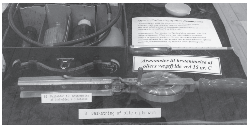
Aræometer til måling af oliers vægtfylde til brug for beskatning af olie og benzin. Fotograf: Leon Jespersen.
