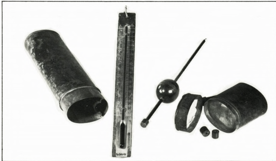
Mads Pedersen Spendrups alkoholometer i etui med tilhørende termometer og ekstra lodder i et lille rum i låget. Toldmuseet.
